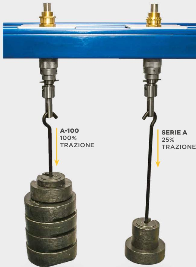
Un pressacavo della serie A-100 e un pressacavo standard della serie A durante le prove di resistenza all'estrazione del cavo.
